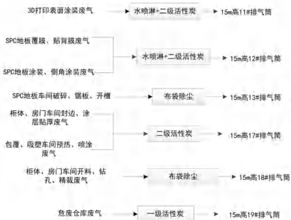
图 3-2 废气污染防治工艺
